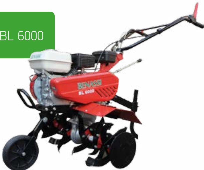
Cambio con ingranaggi in bagno d'olio a 3 velocità (2 AV + 1 RM)
