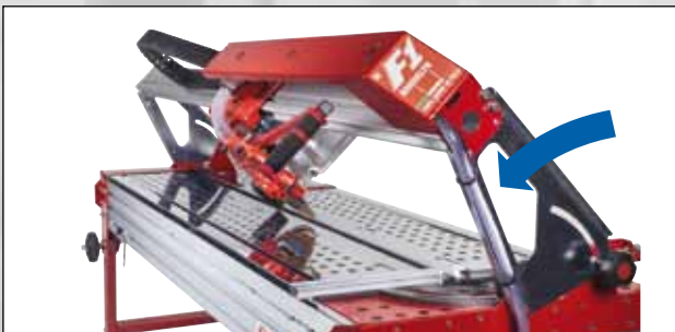
Testa inclinabile per Jolly Tilting head for Jolly Tête inclinable pour faire des biseaux Neigbar für Jolly-Schnitte
